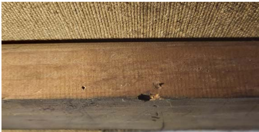
Ilustracja 1: Ślady piły fabrycznej na dolnej poprzeczce krosna obrazu Brodiaga A. Sochaczewskiego, fot. Anna Dębska
