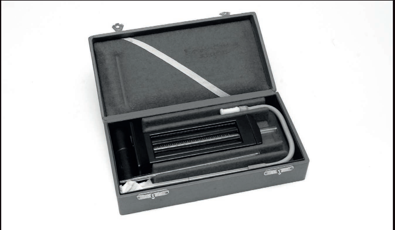
19. Hemocytometr – aparat do badań hematologicznych (Zählapparate nach Thoma) służył do liczenia krwinek czerwonych
